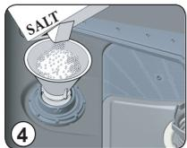
Diese Maschine ist mit einem Wasserenthärter ausgestattet. Füllen Sie hierzu den Geschirrspüler mit Salz.
