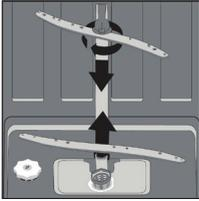
Die Sprüharme müssen regelmäßig gereinigt werden. Verschmutzung verstopft auf Dauer die Sprühköpfe und die Lager der Sprüharme. Reinigen Sie die Sprüharme folgendermaßen:
