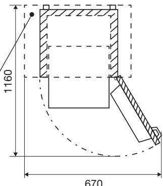
**Stellen Sie sicher, dass um das Gerät herum genügend Platz vorhanden ist, damit eine gute Belüftung und Luftströmung um das Gerät herum möglich ist.**
