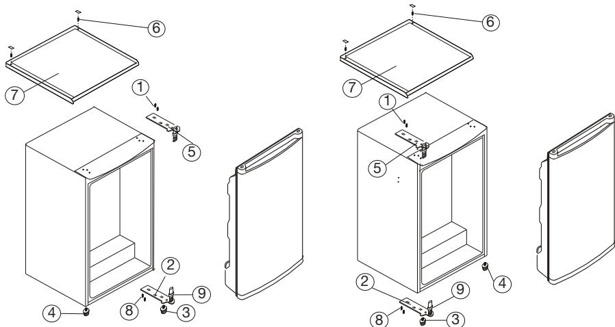
1. Verwijder de afdekplaatjes en de schroeven (6) van het bovenpaneel (7).
