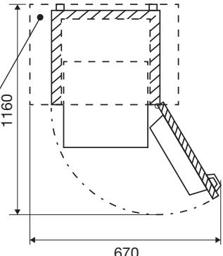
Veillez à ce qu'il y ait suffisamment d'espace autour de l'appareil pour permettre une ventilation correcte et une bonne circulation de l'air autour de l'appareil.
