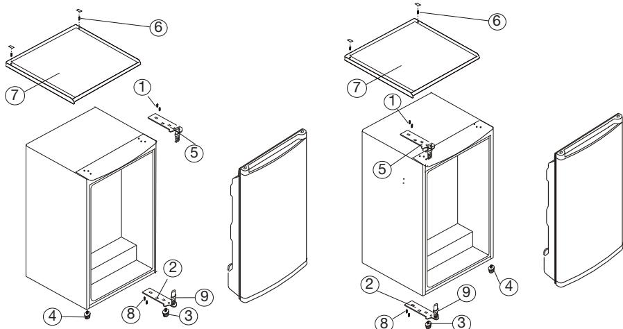
1. Entfernen Sie die Abdeckplatten und die Schrauben (6).
