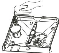
Deze machine is uitgerust met een waterontharder. Vul hiervoor de vaatwasmachine met zout.
