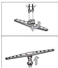
Die Sprüharme müssen regelmäßig gereinigt werden. Verschmutzung verstopft auf Dauer die Sprühköpfe und die Lager der Sprüharme.
