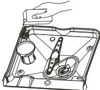
Cette machine est équipée d'un anticalcaire. A cet effet, remplissez le lave-vaisselle de sel.
