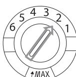
Le réservoir de liquide de rinçage a 6 positions. Réglez en premier lieu le réservoir sur la position 2. Si des taches continuent d'apparaître sur la vaisselle, augmentez la quantité de liquide de rinçage en tournant le bouton du réservoir sur la position 3. Si cela n'entraîne aucune amélioration, réglez le bouton sur une position supérieure. Répétez cette opération jusqu'à ce que la vaisselle sorte sèche et sans traces de la machine.
