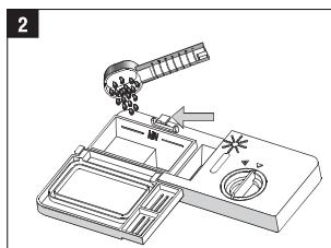
1. Appuyez sur le déverrouillage si le couvercle est fermé. Le couvercle s'ouvre.
