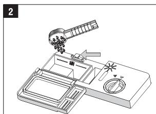
1. Drücken Sie bei geschlossenem Deckel auf die Entriegelung. Der Deckel springt auf.
