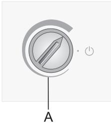
Si la température de la pièce dans laquelle l'appareil est installé est inférieure à 16°C, nous vous recommandons de régler le bouton du thermostat **A** vers la **partie plus large du symbole**.
