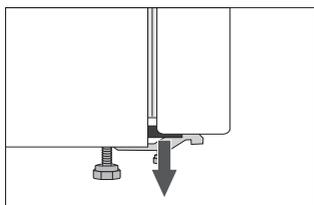
Enlevez-les et insérez à la place, dans les orifices, les caches livrés avec l'appareil (uniquement pour certains modèles).
