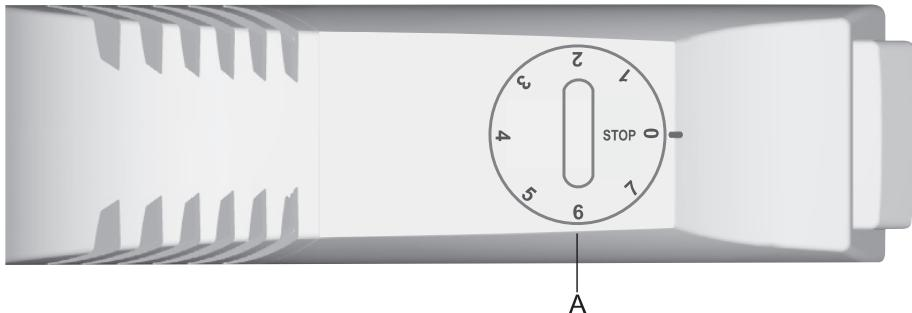
A Bouton du thermostat : réglage de la température et Marche/Arrêt
