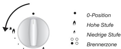
Falls die Flammen versehentlich ausgehen, drehen Sie den Schalter in die „Aus“-Position, warten Sie 60 Sekunden und entzünden Sie den Brenner erneut, wie beschrieben.
