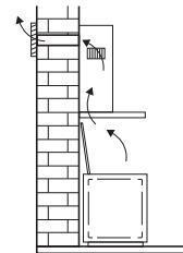
2. Par recyclage. Lorsque la hotte est raccordée à une hotte de recyclage, les particules grasses et les odeurs des vapeurs de cuisson extraites sont filtrées. L'air aspiré n'est pas évacué à l'extérieur, mais recyclé dans la cuisine. Dans ce cas, il convient d'installer un filtre à charbon.
