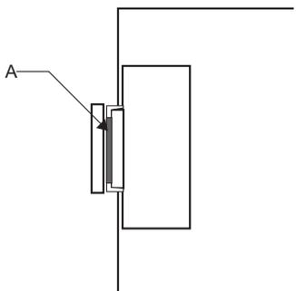
L'indicateur « porte ouverte » (A) sur la fermeture de la porte du compartiment congélateur indique si la porte est correctement fermée ou non.
