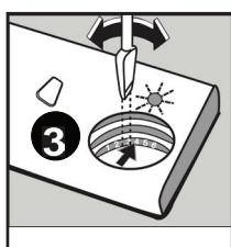
1. Draai de dop van het glansspoelmiddelreservoir open (naar links, naar de pijl met "open").
