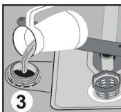
**Attention !** Remplissez toujours le réservoir de sel et réglez la dureté de l'eau avant de mettre en service le lave-vaisselle. Remplissez le réservoir de sel quand le voyant de l'anticalcaire (2) s'allume. Il peut arriver que le voyant reste allumé un certain temps bien que le réservoir de sel soit rempli. Il s'éteint lorsque sel s'est suffisamment dissous dans l'eau.
