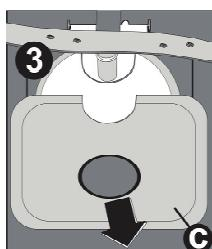
Afhankelijk van het gebruik moeten de zeven regelmatig onder de kraan afgespoeld worden. Het filtersysteem bestaat uit drie componenten: de grote zeef, de grove zeef en de fijne zeef.
