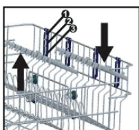
De bovenkorf is uitgevoerd met 4 zijrekken (2 aan beide kanten).
