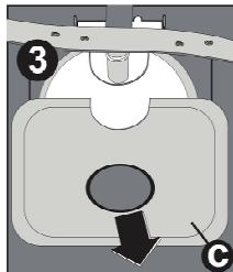
En fonction de l'utilisation, les tamis doivent être régulièrement rincés sous l'eau du robinet. Le système de filtration est composé de trois éléments : le grand tamis, le gros tamis et le tamis fin.
