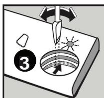
Le réservoir de liquide de rinçage a 6 positions. Le réservoir est réglé en standard sur la position 3. Réglez en premier lieu le réservoir sur la position 2. Si des taches continuent d'apparaître sur la vaisselle, augmentez la quantité de liquide de rinçage en tournant le bouton du réservoir sur la position 3. Si cela n'entraîne aucune amélioration, réglez le bouton sur une position supérieure. Répétez cette opération jusqu'à ce que la vaisselle sorte sèche et sans traces de la machine.
