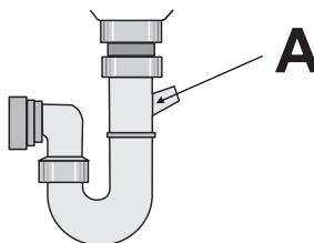
**i** Unsere Geräte verfügen über eine Sicherheitseinrichtung, die den Rückfluss von Schmutzwasser in die Maschine verhindert. Falls der Siphon Ihrer Spüle mit einem "Rückschlagventil" ausgestattet ist, kann dadurch der Ablauf Ihres Geschirrspülers beeinträchtigt werden. Sie sollten das Ventil daher entfernen.
