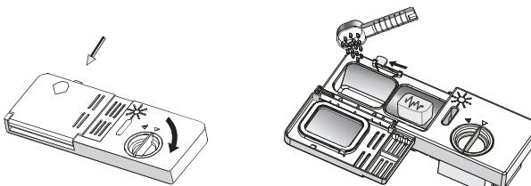
1. Drücken Sie bei geschlossenem Deckel auf die Entriegelung. Der Deckel springt auf.
