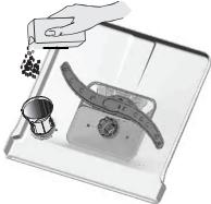
Deze machine is uitgerust met een waterontharder. Vul hiervoor de vaatwasmachine met zout.
