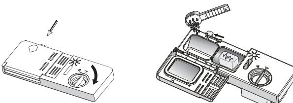
1. Appuyez sur le déverrouillage si le couvercle est fermé. Le couvercle s'ouvre.
