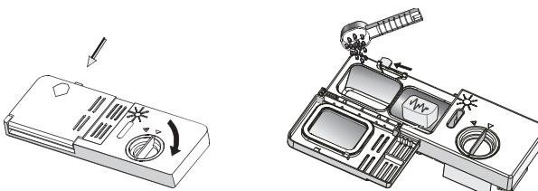
1. Druk op de ontgrendeling als de deksel gesloten is. De deksel springt open.
