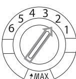
Le réservoir de liquide de rinçage a 6 positions. Réglez en premier lieu le réservoir sur la position 2. Si des taches continuent d'apparaître sur la vaisselle, et si la vaisselle ne sèche pas bien, augmentez la quantité de liquide de rinçage en tournant le bouton du réservoir sur la position 3. Si cela n'entraîne aucune amélioration, réglez le bouton sur une position supérieure. Répétez cette opération jusqu'à ce que la vaisselle sorte sèche et sans traces de la machine.
