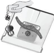
Cette machine est équipée d'un anticalcaire. A cet effet, remplissez le lave-vaisselle de sel.
