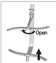
Die Sprüharme müssen regelmäßig gereinigt werden. Verschmutzung verstopft auf Dauer die Sprühköpfe und die Lager der Sprüharme. Reinigen Sie die Sprüharme folgendermaßen:
