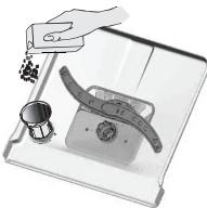
Diese Maschine ist mit einem Wasserenthärter ausgestattet. Füllen Sie hierzu den Geschirrspüler mit Salz.
