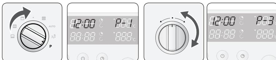
**1** Positionnez le **bouton de sélection de la cavité** sur le mode d'auto-nettoyage.
