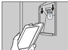
1. Pour retirer le cache en verre, soutenez sa partie inférieure d'une main, puis insérez un outil pointu et plat (ex. : couteau de table) entre le verre et le cadre afin d'extraire le cache.
