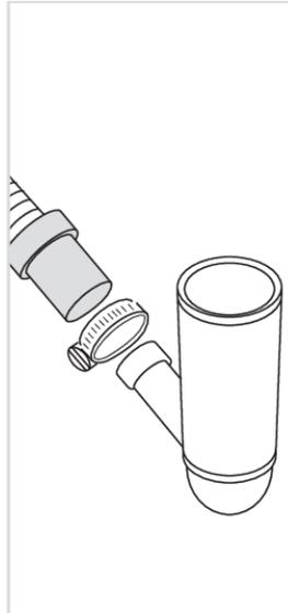
Der Abflussschlauch kann auch mit einem Anschlussnippel in der Wasserleitung des Ablaufes verbunden werden. Der Anschlussnippel muss einen Innendurchmesser von mindestens 14 mm haben.
