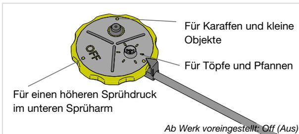
Lassen Sie die Leistungszonen geöffnet, wenn Sie dort einen erhöhten Wasserdurchfluss wünschen, weil Sie zum Beispiel Kochtöpfe und Bratpfannen oder Karaffen und kleine Objekte in die Maschine gelegt haben. Schalten Sie die Leistungszonen des Geschirrspülers aus, wenn Sie einen höheren Sprühdruk im unteren Sprüharm wünschen.
