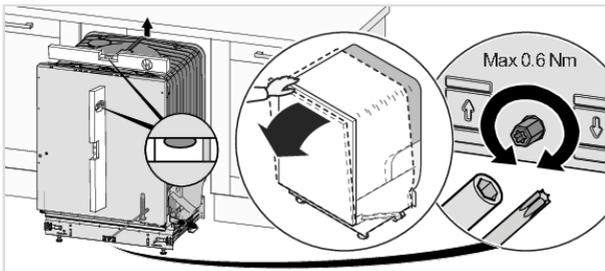
4. Stellen Sie die vorderen Standfüße ein, indem Sie sie im Uhrzeigersinn drehen, um den Geschirrspüler anzuheben und gegen den Uhrzeigersinn, um den Geschirrspüler abzusenken.
