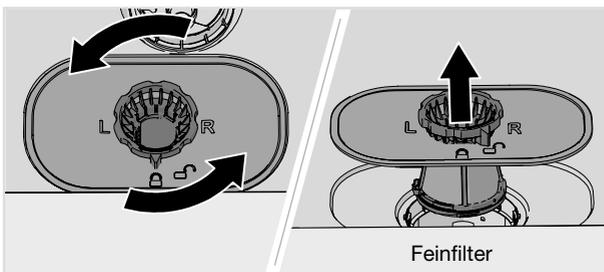
1. Drehen Sie den Arretierring gegen den Uhrzeigersinn und heben Sie den Feinfilter gerade nach oben heraus.
