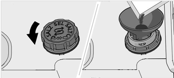
1. Drehen Sie den Deckel des Salzbehälters gegen den Uhrzeigersinn, um ihn abzunehmen.
