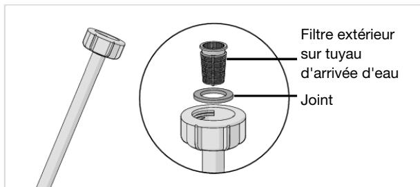
Filtre extérieur sur tuyau d'arrivée d'eau
