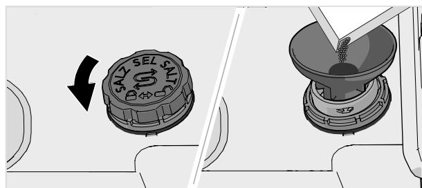
1. Maak het deksel van het zoutreservoir los door het tegen de klok in te draaien.
