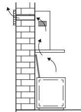
2. Comme hotte aspirante à recirculation d'air. Les particules de graisse et les odeurs des vapeurs aspirées sont filtrées. L'air aspiré ne sera pas évacué, mais remis en circulation vers la cuisine d'où il provient. Vous devez dans ce cas mettre en place filtres à charbon.
