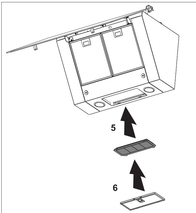
Die regenerierbare Aktivkohlefilter müssen per Hand mit klarem Wasser oder im Geschirrspüler bei einer Höchsttemperatur von 65 °C gereinigt werden. Bei Reinigung im Geschirrspüler dürfen sich keine Teller, Geschirr, Tassen usw. im Spüler befinden. Keine Reinigungsmittel verwenden!
