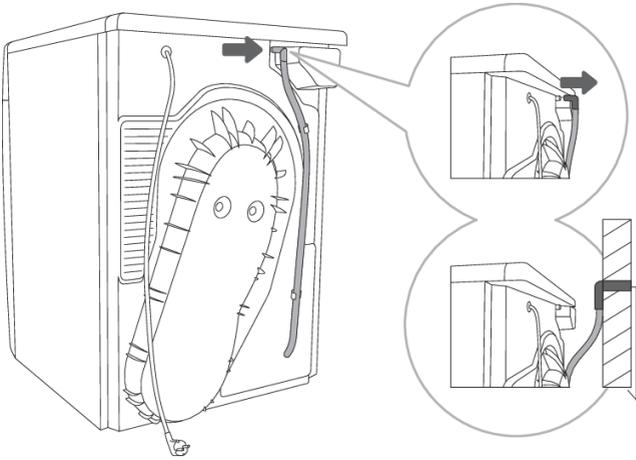
**1** Enlevez le tuyau fixé à un support à l'arrière de l'appareil (à gauche, sous le couvercle).
