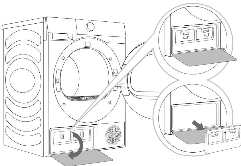
**1** Appuyez sur la boucle du couvercle de la porte de l'échangeur thermique située en bas à gauche pour ouvrir le couvercle de la porte.
