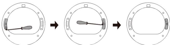
**7** Retirez la vis du dispositif de verrouillage du hublot de l'ensemble avant, tirez le dispositif de verrouillage du hublot verticalement à la main, descendez-le et faites-le pivoter de 180° vers l'autre côté. Ensuite, installez-le dans le trou de l'ensemble avant, tirez-le vers le bas pour le serrer et serrez les vis. L'inversion du verrouillage du hublot est maintenant terminée.
