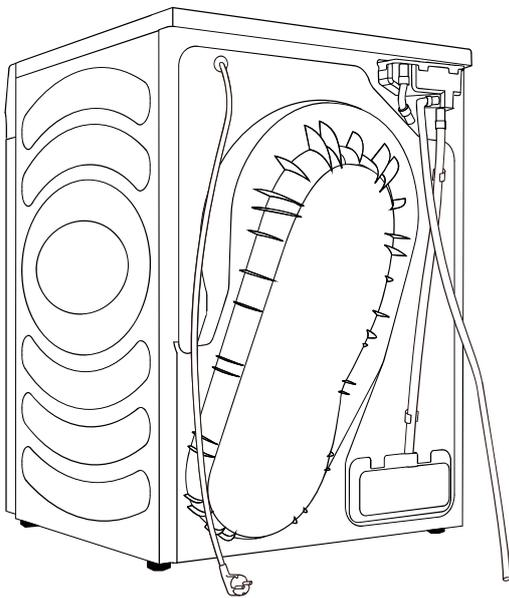
**1** Retirez le tuyau d'évacuation de la machine et accrochez-le à l'arrière.
