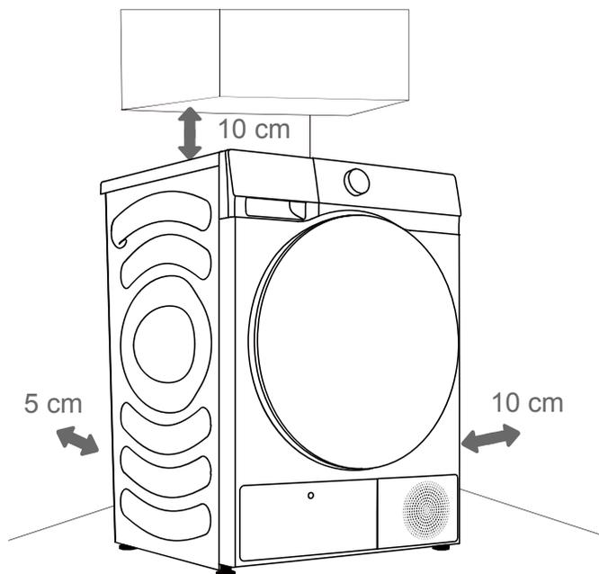
⚠ Le sèche-linge ne doit pas être en contact avec un mur ou un meuble adjacent. Pour un fonctionnement optimal de l'appareil, laissez un espace autour de l'appareil comme indiqué sur la figure. Le non-respect des espaces minimum requis peut entraîner une surchauffe.
