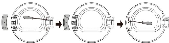
**6** Faites pivoter la plaque de recouvrement de la charnière et la plaque de recouvrement du crochet du hublot de 180° respectivement et installez-les aux positions correspondantes de l'autre côté du cadre intérieur, puis serrez les vis.
