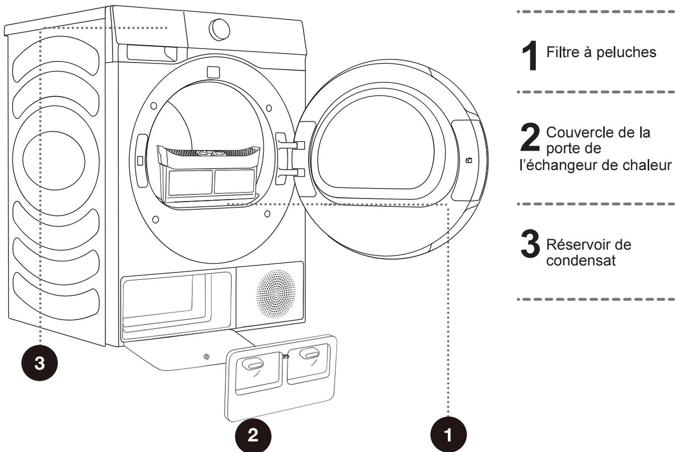
⚠ N'utilisez jamais l'appareil sans les filtres en place ou avec des filtres endommagés, car les fibres accumulées à partir des textiles pourraient entraîner un mauvais fonctionnement ou une défaillance du sèche-linge.
