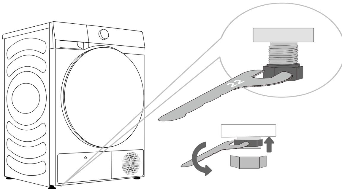
⚠ Le sol sur lequel est posé le sèche-linge doit avoir une base en béton. Il doit être propre et sec, sinon le sèche-linge risque de glisser. Nettoyez également le dessous des pieds réglables.
