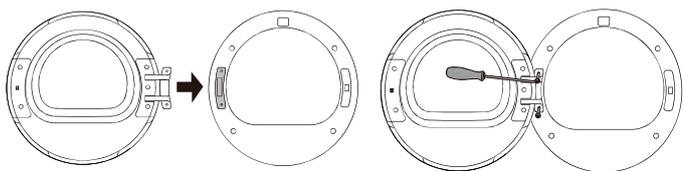
**8** Enfin, installez la charnière du hublot sur l'ensemble avant, serrez les deux vis et fermez le hublot. L'inversion du hublot (de l'ouverture gauche à l'ouverture droite) est maintenant terminée.
