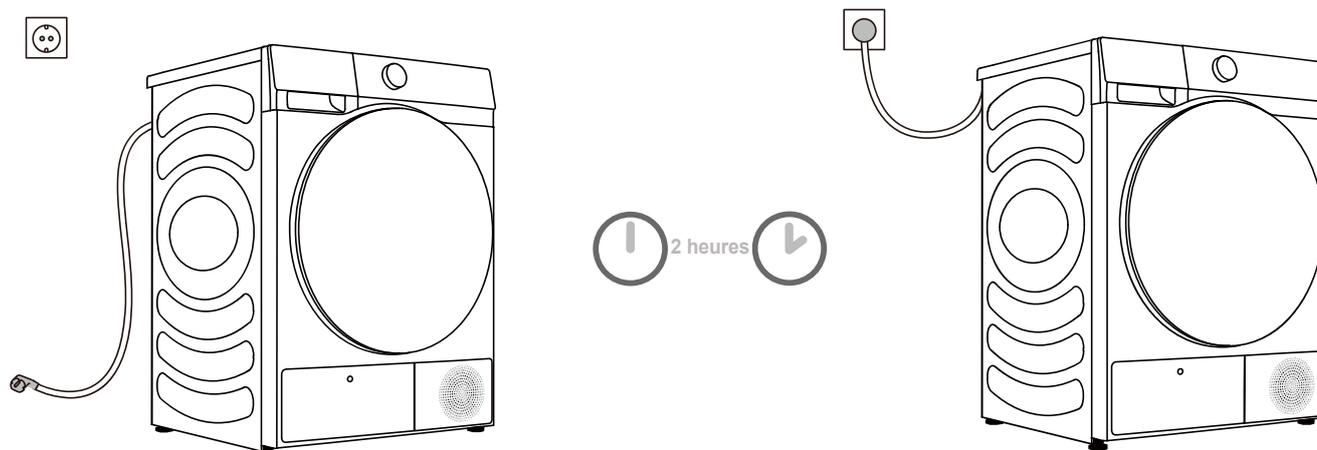
**⚠️ Après l'installation, le sèche-linge doit rester immobile pendant deux heures avant d'être branché au réseau électrique. Cela permet au sèche-linge de se stabiliser.**
