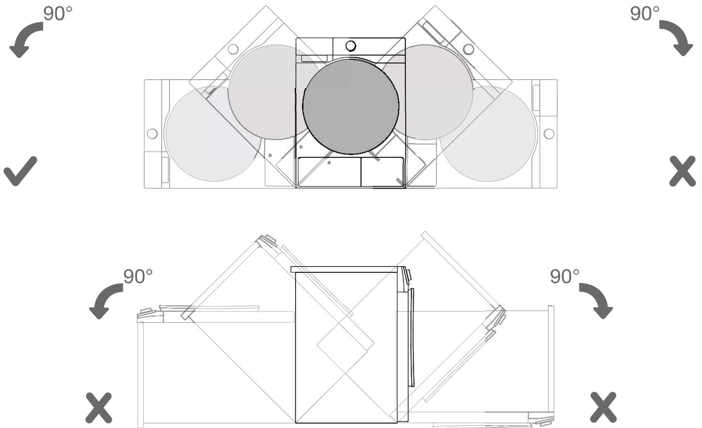
⚠ Après l'installation, attendez 24 heures sans déplacer l'appareil avant de l'utiliser pour la première fois. Si le sèche-linge doit être couché sur l'un des côtés pendant le transport ou l'entretien, placez-le avec son côté gauche, vu de l'avant de l'appareil, vers le bas.
