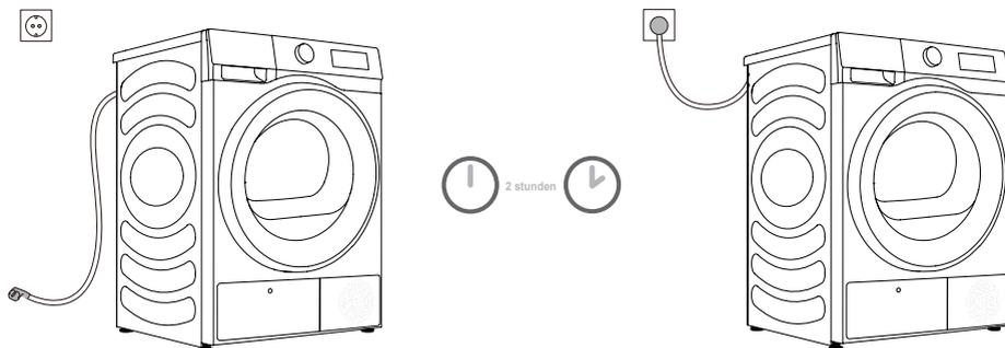
**⚠ Nach der Installation muss der Trockner für zwei Stunden stillstehen, bevor er am Stromnetz angeschlossen wird; auf diese Weise kann sich der Trockner stabilisieren.**
