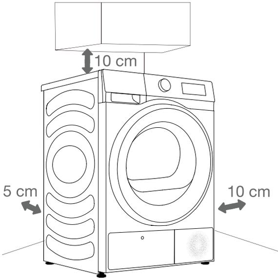
☼ Das Gerät darf nicht mit einer Wand oder einem Möbelstück in Berührung kommen. Um einen optimalen Betrieb zu gewährleisten, lassen Sie um das Gerät herum etwas Platz, wie in der Abbildung angegeben. Wenn Sie die erforderlichen Mindestabstände nicht einhalten, kann es zu einer Überhitzung kommen.
