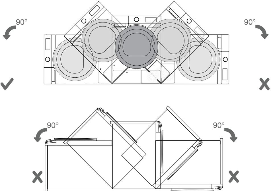
⚡ Warten Sie nach der Installation 24 Stunden, ohne das Gerät zu bewegen, bevor Sie es zum ersten Mal benutzen. Wenn der Trockner während des Transports oder der Wartung auf eine Seite gelegt werden muss, legen Sie ihn nur mit der linken Seite, von der Vorderseite des Geräts aus gesehen, nach unten.
