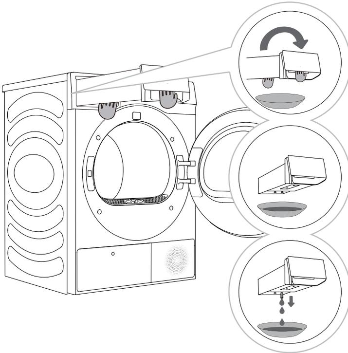
**1** Ziehen Sie den Kondensatbehälter aus dem Trockner (mit beiden Händen, wie in der Abbildung gezeigt).
