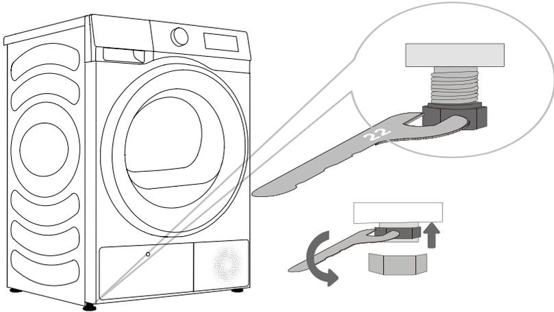
☞ Der Boden, auf dem das Gerät aufgestellt wird, muss aus Beton sein. Er muss sauber und trocken sein, sonst kann das Gerät rutschen. Reinigen Sie auch die Unterseite der Einstellfüße.
