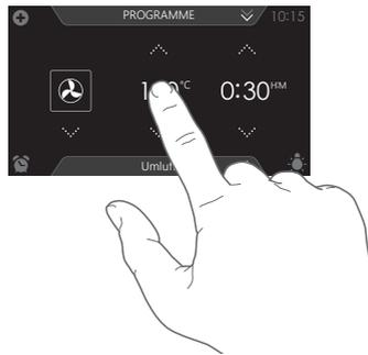
1. Tippen Sie auf die Mitte des Funktionssymbols, der Temperatur, der Leistung oder der Garzeit (aktiviert). Die Tastatur wird angezeigt.
