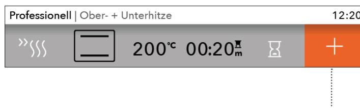
Drücken Sie zur Zugabe des Dampfes das **Symbol +**. Bestätigen Sie die Einstellung durch Drücken des KNEBELS.
