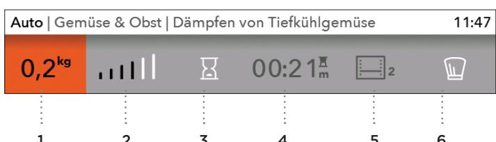
Es werden die voreingestellte Werte angezeigt: Sie können die Menge, die Bräunungsstufe und die Einschaltverzögerung (Betriebsende) einstellen.
