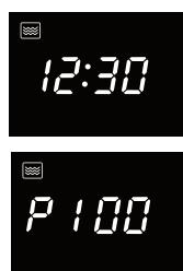
1. Appuyez sur la touche de démarrage pour lancer la cuisson à 100 % de puissance pendant 30 secondes. Chaque appui supplémentaire sur la touche, augmente la durée de 30 secondes (de 0:05 à 95:00).
