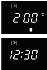
4. Tournez le bouton de réglage pour sélectionner la température de convection (de 140 à 230 °C).
