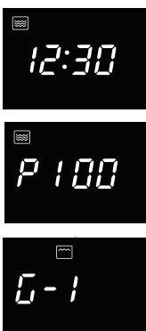
1. Betätigen Sie die Schnelltaste, um 30 Sekunden lang mit 100 % Leistung zu garen. Jeder weitere Tastendruck erhöht die Zeit um weitere 30 Sekunden (00:05 bis 95:00).
