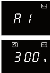
1. Stellen Sie mit dem Drehschalter das gewünschte Automatikprogramm ein. Die blinkende Anzeige „A1“, „A2“, „A3“ ... „A10“ steht für die jeweilige Automatikfunktion.
