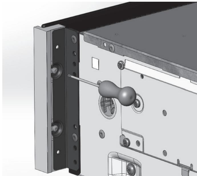
De voorkant is enkele millimeters in te stellen om uit te lijnen met andere apparaten. Dit kan met een inbus sleutel aan de onderzijde van het apparaat.
