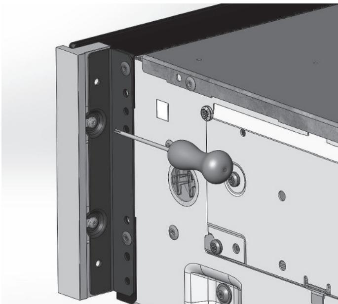
La face avant peut être réglée sur quelques millimètres, afin de permettre un alignement avec les autres appareils. Utilisez pour ce faire une clé de serrage, en partie basse de l'appareil.
