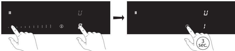
9. Vérifiez si la connexion a réussi en rallumant la table de cuisson. Si l'éclairage de la hotte aspirante s'allume, la connexion a réussi.
