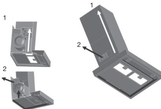
De afzuigkappen met Duo Logic HR zijn voorzien van een uitwasbaar long-life koolstoffilter en zijn stiller en energiezuiniger dan de conventionele afzuigkappen. Bij gewoon of uitgebreid koken worden vrijwel alle geurtjes en dampen gevangen. Dankzij het recirculatiesysteem verdwijnt niet alle lucht naar buiten. Een deel van de afgezogen lucht wordt namelijk na filtering weer teruggebracht in de keuken. Hierdoor verbriukt u minder energie.
