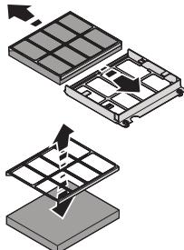
die Geschirrspülmaschine bei 65°C. (Wählen Sie bei Verwendung der Spülmaschine die Funktion für einen vollen Zyklus und spülen Sie den Filter ohne Geschirr.)
