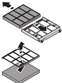
nécessité) dans un grand volume d'eau chaude additionnée d'un détergent adapté, ou au lave-vaisselle à 65 °C (au lave-vaisselle, choisissez un cycle complet et ne mettez pas de vaisselle).
