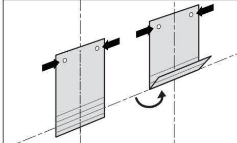
2. Legen Sie Schablone des Haubentyps auf die Linie (oder falten Sie die Schablone auf der Haubenlinie), markieren und bohren Sie die oberen Löcher (2x ø 10 mm).
