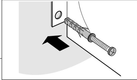
6. Bohren Sie die Bohrlöcher (2x ø 6 mm). Sichern Sie den Motormodul mit den mitgelieferten Nageldübeln (6 x 60).
