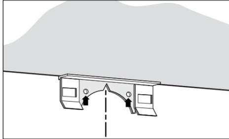
2. Bringen Sie die Mitte des Haltebügels auf der Mittellinie (gegen die Decke) an. Markieren und bohren Sie die Befestigungslöcher (ø 8 mm).
