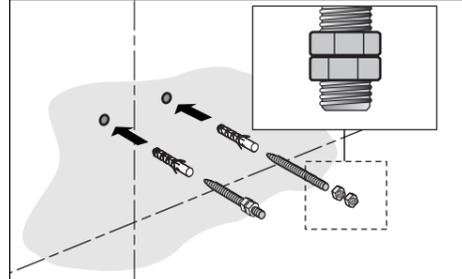
3. Befestigen Sie die Dübel. Drehen Sie 2 Muttern in entgegengesetzter Richtung auf die Stiftschrauben. Drehen Sie die Stiftschrauben in die Wand.
