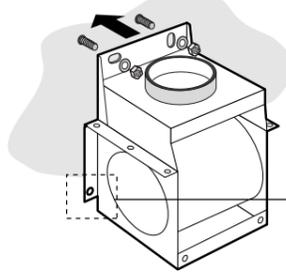
5. Hängen Sie den Motormodul an den Stiftschrauben auf. Ziehen Sie die Muttern fest. Sorgen Sie dafür, dass der Modul waagrecht hängt.
