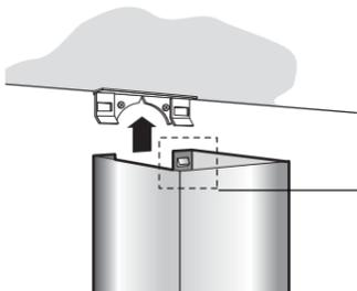
1. Schieben Sie das obere Teleskoprohr hinter den Haltebügel bis zur Decke.
