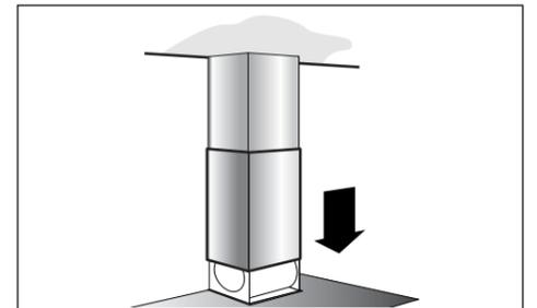
4. Lassen Sie das untere Teleskoprohr auf die Haube gleiten. Befestigen Sie die Filter und testen Sie die Funktion der Dunstabzugshaube.
