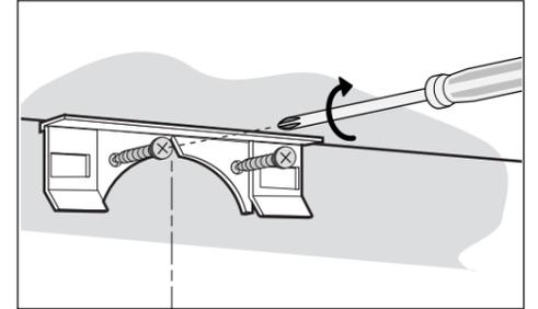
4. Montieren Sie den Haltebügel mit den mitgelieferten Schrauben (5 x 50 mm) an der Wand.
