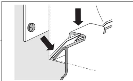
2. Haken Sie die Rückseite von unten in den Motormodul ein.
