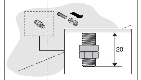
4. Lassen Sie 20 mm der Stiftschrauben aus der Wand herausragen. Entfernen Sie die Muttern.
