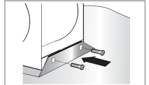
4. Schrauben Sie die beiden mitgelieferten Bolzen (M5x12) in die Haube, aber noch nicht fest anziehen. Richten Sie die Haube waagrecht aus und schrauben Sie diese jetzt gut fest.
