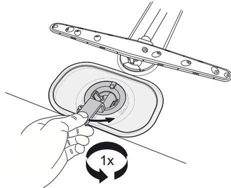
2. Ziehen Sie den Rohrabschnitt über den Griff gerade nach oben. Lösen Sie den Grobfilter, um den Rohrabschnitt zu reinigen.
