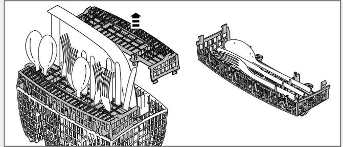
Der Besteckkorb-Deckel kann entfernt und beispielsweise als zusätzlicher Besteckkorb im oberen Korb verwendet werden (siehe unten).
