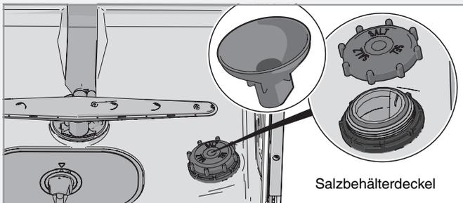
Wenn nicht mehr genügend Salz vorhanden ist, schrauben Sie den Deckel ab und füllen Sie den Behälter mit Salz. Wasser wird nur beim ersten Mal hinzugefügt! Entfernen Sie Rückstände und verschließen Sie den Deckel. Starten Sie ein Programm, so dass sämtliche Salzreste im Geschirrspüler weggespült werden.
