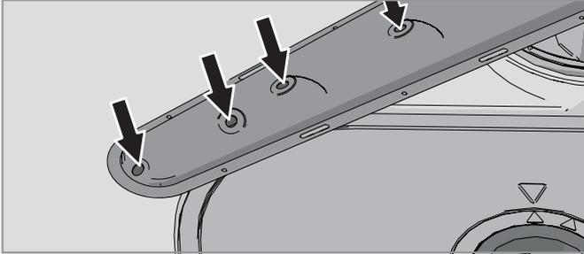
Zur einfacheren Reinigung können Sie die Sprüharme entfernen. Vergessen Sie aber nicht, sie nach der Reinigung wieder ordnungsgemäß anzubringen.
