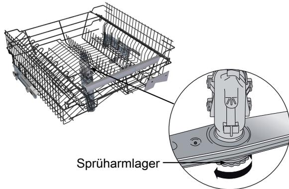
3. Reinigen Sie den oberen Sprüharm auf die gleiche Weise wie den unteren Sprüharm.
