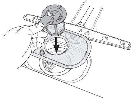
5. Arretieren Sie den Filter, indem Sie den Griff im Uhrzeigersinn bis zur Einrast-Position drehen. Der Griff sollte gerade aus dem Geschirrspüler herausragen.
