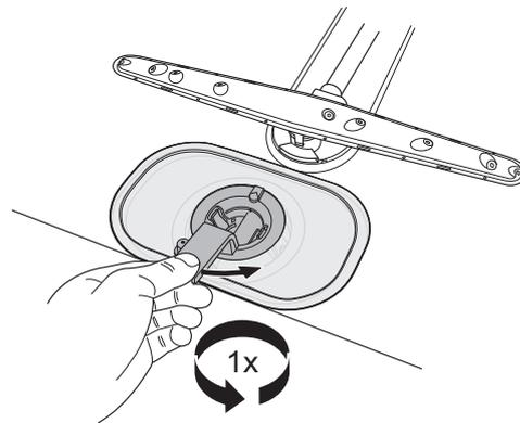
3. Den Feinfilter abnehmen und reinigen.
