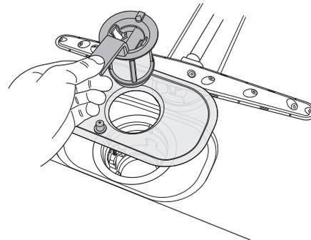
5. Den Filter in seiner Position verriegelt. Hierzu den Griff im Uhrzeigersinn verriegeln zum Anschlag drehen. Der Griff muss aus dem Geschirrspüler herauszeigen.
