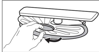
4. Reinigen Sie die Filter.
