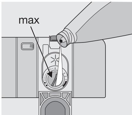
Das Dosiergerät fasst ca. 110 ml Klarspülmittel; die Menge reicht je nach der Dosiereinstellung für 16 bis 40 Spülzyklen.
