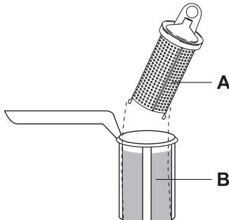
3. Drehen Sie den Griff um 1/4 Umdrehung nach links und ziehen Sie das Filtersystem heraus
