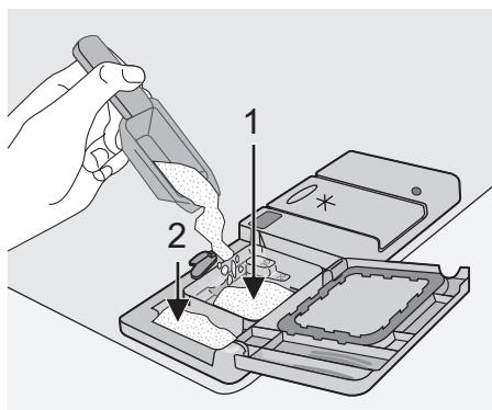
3. Tous les programmes avec prélavage nécessitent une dose supplémentaire de produit de lavage (5 à 10 g) à placer dans le compartiment de prélavage (2). Ce produit de lavage agira au cours de la phase de prélavage.
