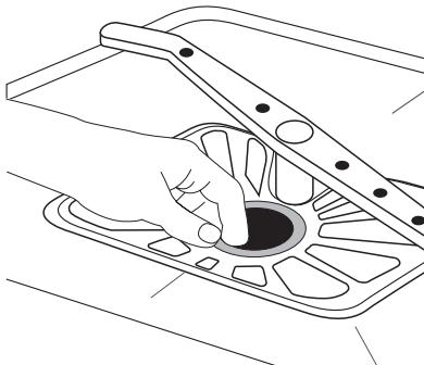
7. Setzen Sie das Filtersieb wieder in den Spülraumboden ein und vergewissern Sie sich, dass es fest sitzt.
