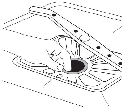
7. Réinstallez le filtre plat dans le fond du compartiment de lavage en veillant à ce qu'il soit bien installé.
