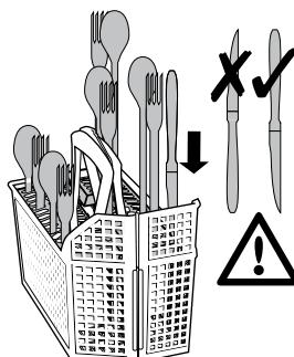
Falls die Griffe auf der Unterseite aus dem Korb ragen und den unteren Sprüharm behindern, das Besteck mit nach oben gerichtetem Griff laden.
