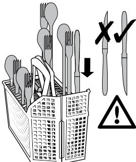
Als de handgrepen onder de bestekmand uitsteken en de onderste sproeiarm in zijn beweging belemmeren, dient het bestek met de handgrepen omhoog te worden geplaatst.
