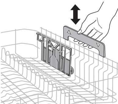
4. Abaissez-le verticalement. Le mécanisme enclenche le panier dans sa position la plus haute ou la plus basse.
