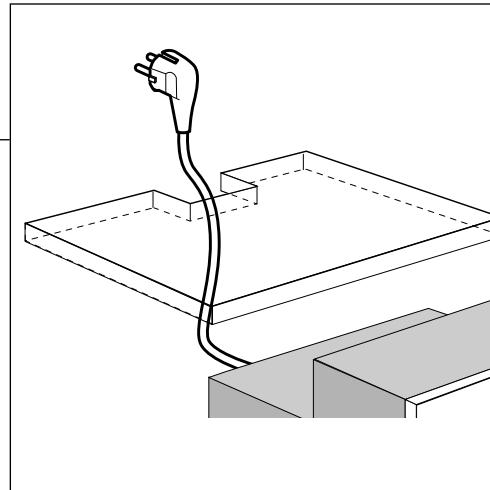
2. Leid de aansluitkabel van de oven naar de plaats waar het aansluitpunt zit.
