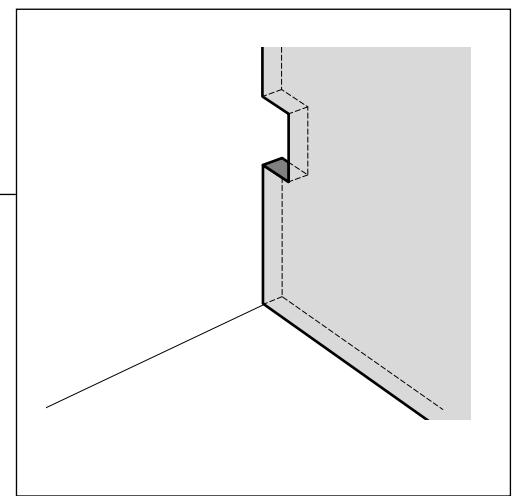
Maak een uitsparing in de zijwand van de keukenkast voor het doorvoeren van het aanslutsnoer.
