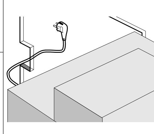
2. Leid de aansluitkabel van de oven naar de plaats waar het aansluitpunt zit.
