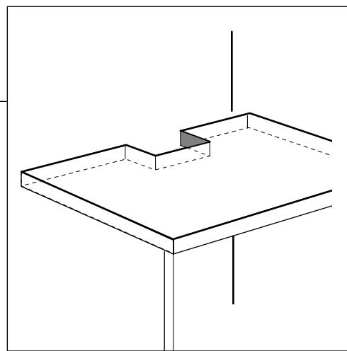
Maak een uitsparing in het onder- of bovenpaneel van de keukenkast voor het doorvoeren van het aanslutsnoer.
