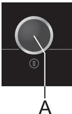
**Het apparaat inschakelen:** Druk op knop A en houd deze 3 seconden ingedrukt.
