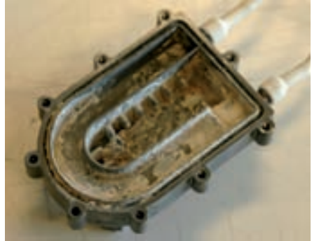
Verkalkt element van een willekeurig toestel
