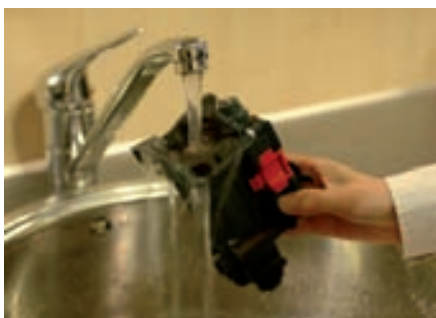
Onderste zetgroep reinigen
