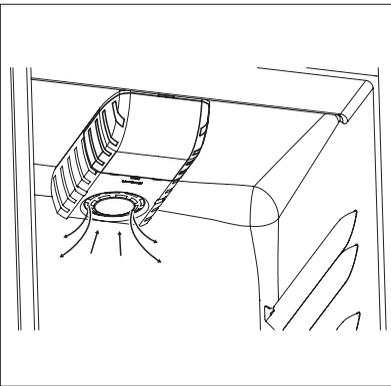
Het koelvak is voorzien van een speciale AIRLIGHT-ventilator die automatisch gaat werken naar aanleiding van de thermostaatinstellingen of de omgevingstemperatuur.
