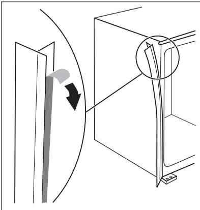
Bringen Sie den selbstklebenden Dichtungsstreifen, wie in der Abbildung gezeigt, am Gerät an.
