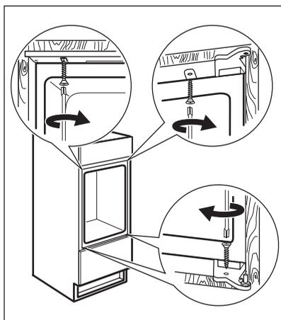
Fixez l'appareil au meuble d'encastrement à l'aide de 4 vis.
