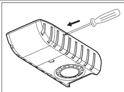
Retirez le diffuseur de l'ampoule en appuyant dessus à l'aide d'un outil (par exemple, un tournevis) afin de libérer les crochets arrière.
