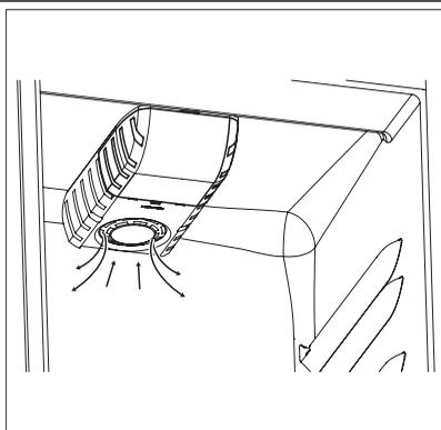
Le compartiment réfrigérateur est doté d'un ventilateur spécial AIRLIGHT qui est automatiquement activé en fonction du réglage du thermostat de l'appareil et des conditions ambiantes.
