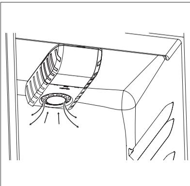
Das Kühlfach ist mit einem Spezialgebläse AIRLIGHT ausgestattet, das automatisch über die Thermostateinstellung des Geräts und die Außentemperaturen eingeschaltet wird.
