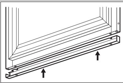
Positionieren Sie die Ausgleichsvorrichtung wie abgebildet mit dem oberen Teil unter den Schraubenköpfen.
