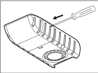
Drücken Sie zum Beispiel mit einem Schraubendreher gegen die Lampenabdeckung, damit die hinteren Haken gelöst werden.
