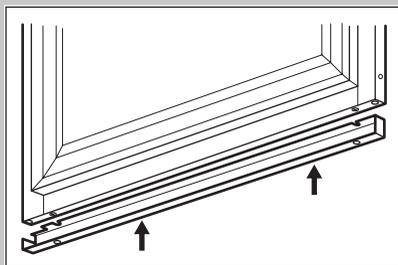
Plaats de stalen compensator zoals aangegeven in de afbeelding en plaats het bovenste gedeelte onder de kop van de schroeven.
