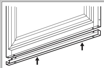
Positionnez le compensateur en acier comme indiqué dans la figure, puis insérez la partie supérieure sous la tête des vis.
