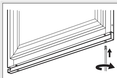
Richten Sie die Ausgleichsvorrichtung an der Türverkleidung aus und ziehen Sie die Schrauben fest.
