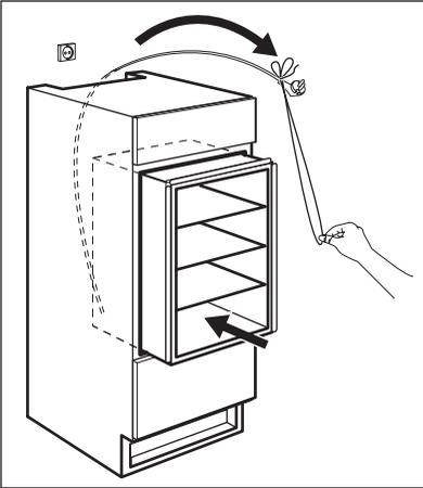
Befestigen Sie das Gerät mit 4 Schrauben in der Einbaunische.
