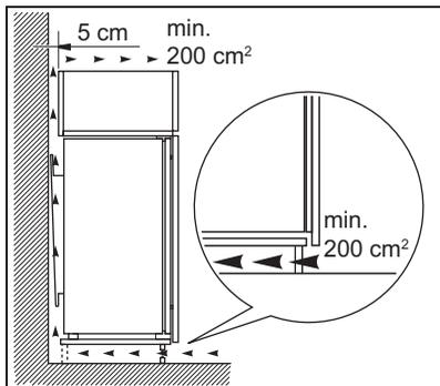
Veillez à garantir une circulation d'air suffisante à l'arrière de l'appareil.
