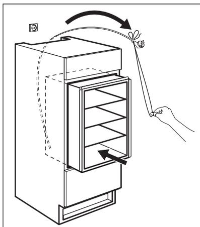
Insérez l'appareil dans le meuble d'encastrement.
