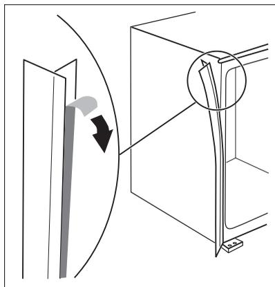
Appliquez la bande isolante adhésive sur l'appareil comme indiqué sur le schéma.
