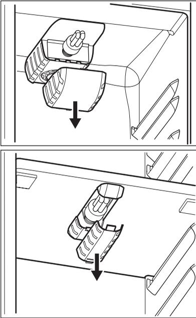
Lösen Sie gleichzeitig den mittleren Haken und ziehen Sie die Abdeckung in Pfeilrichtung heraus.
