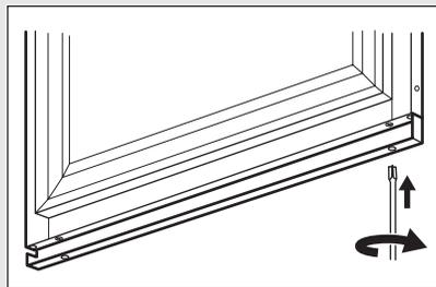
Alignez le compensateur avec le panneau de porte en acier et serrez les vis.
