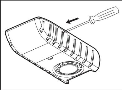
Verwijder het lampenkapje door het naar binnen te drukken met bijvoorbeeld een schroevendraaier om de achterste haken vrij te geven.
