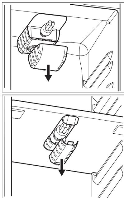
Simultanément, dégagez le crochet intermédiaire et faites glisser le diffuseur dans le sens des flèches.
