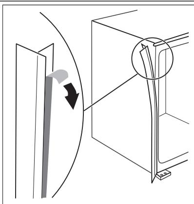
Bevestig de zelfklevende afdichtstrip op het apparaat zoals aangegeven in de afbeelding.
