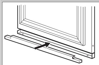
Führen Sie das Schutzblech wie abgebildet in die Ausgleichsvorrichtung ein.
