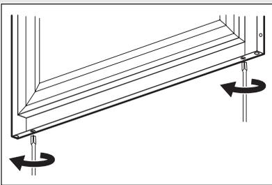
Öffnen Sie die Tür und lockern Sie die beiden Schrauben im unteren Teil, ohne sie jedoch ganz herauszuschrauben.
