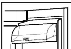
Boter- en kaasvak altijd tegelijkertijd met het deksel verwijderen.
