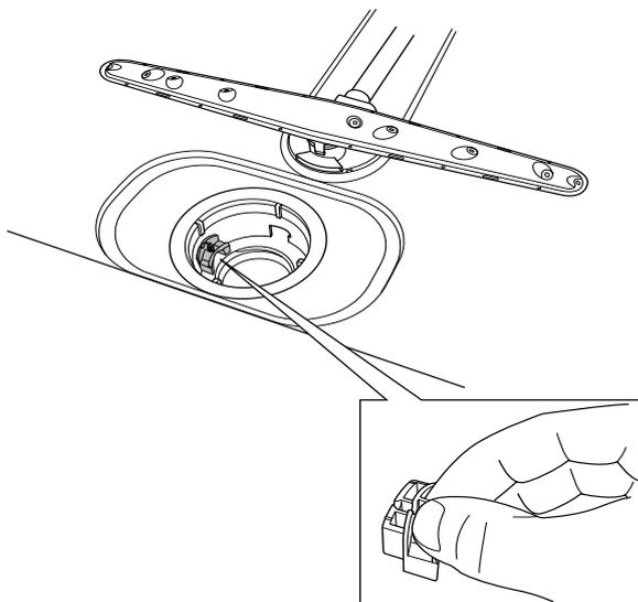
4. Sie können einen Finger in die Öffnung stecken, das Pumpenrad drehen und eventuelle blockierende Gegenstände entfernen.
