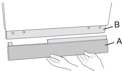
2. Entfernen Sie die beiden Schrauben an der Abdeckplatte (B).
