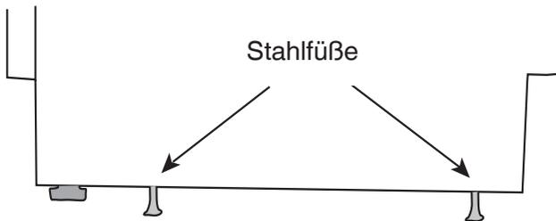
3. Nachdem Sie die Stahlfüße festgestellt haben, drehen Sie die beiden Gummifüße bis zum Fußboden herunter.
