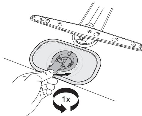
3. Den Feinfilter abnehmen und reinigen.
