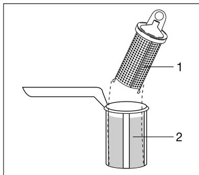
3. Griff etwa um 1/4 Umdrehung entgegen dem Uhrzeigersinn schwenken und herausnehmen.
