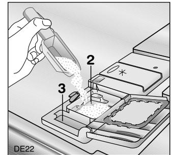
3. Bei allen Programmen mit Vorspülphase muss eine kleine Menge Reinigungsmittel (5/10 g) in die Kammer (3) des Fachs gefüllt werden. Dieser Reiniger wird bereits beim Vorspülen wirksam.
