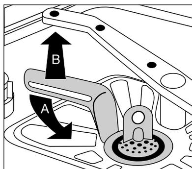
4. Grobsieb (1) an der Grifföse fassen und aus dem Mikrofilter (2) herausziehen.
