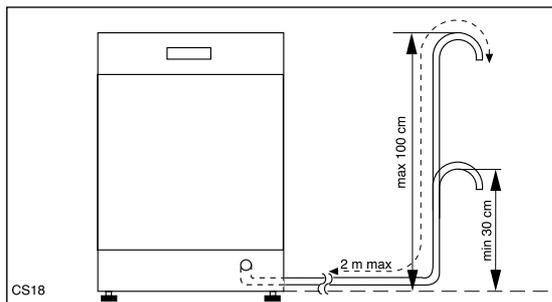
Auch bei eventuellen Anschluss-Stücken für den Schlauchanschluss darf der Innendurchmesser nicht kleiner als der des Ablaufschlauches sein. Der Verlängerungsschlauch soll am Boden liegen, und nur beim Ablauf emporsteigen.
