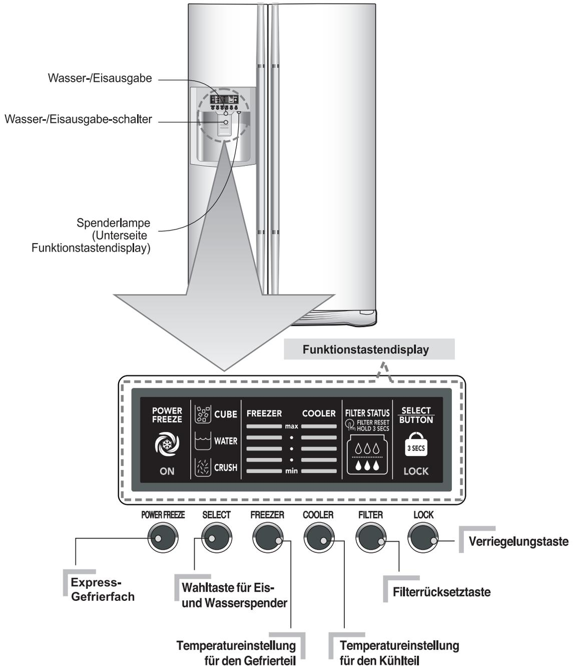
**Die Temperaturen für das Gefrier- und das Kühlschranksfach können separat eingestellt werden.**
