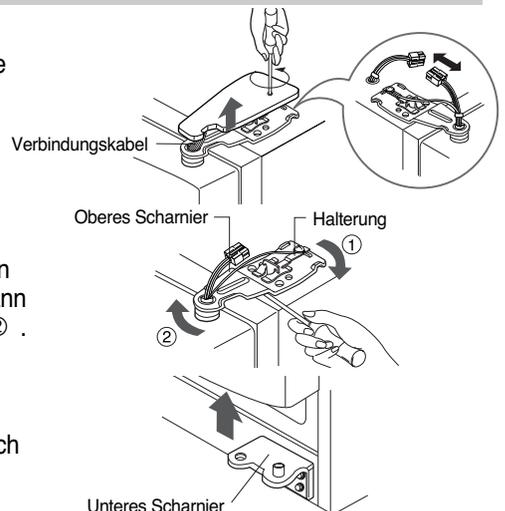
2) Entfernen Sie die Halterung durch Drehen im Uhrzeigersinn ① und entfernen Sie dann das obere Scharnier durch Hochziehen ②.
