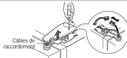
2) Enlevez l'arrêt en le faisant tourner dans le sens des aiguilles d'une montre (①) puis enlevez la charnière supérieure en la soulevant (②).
