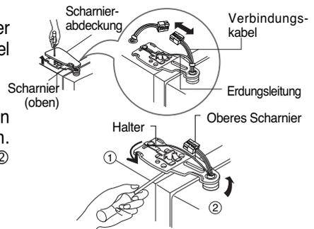
2) Entfernen Sie den Halter, indem Sie diesen entgegen dem Uhrzeigersinn ① drehen. Daraufhin heben Sie das obere Scharnier ② an.
