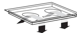
L'électronique qui se trouve dans l'appareil a besoin d'être refroidie. Des événements ont été placés sur la face inférieure de l'appareil. Ils permettent l'aspiration de l'air frais. Sur la partie latérale, l'appareil est équipé de bouches de soufflage. Pour obtenir un refroidissement optimal de la cuisinière, vous devez modifier quelque peu le meuble de cuisine.
