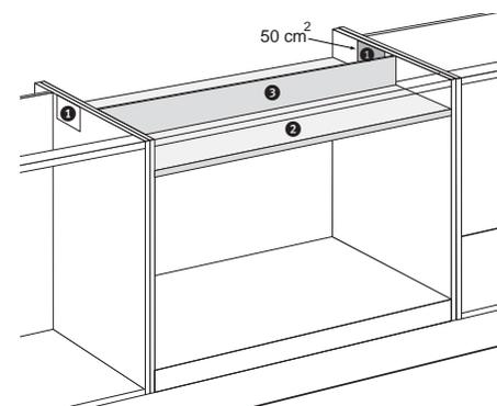
Plaats een schermplaat tussen de oven en de kookplaat. De plaat moet minimaal 10 mm dik zijn en hittebestendig (85 °C). De ruimte tussen de onderzijde van de kookplaat en schermplaat moet minimaal 50 mm bedragen.
