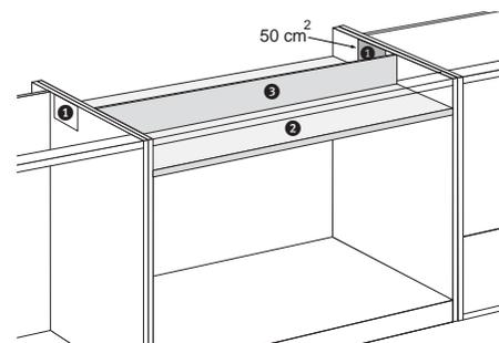
Placez une plaque de protection entre le four et la plaque de cuisson. La plaque doit mesurer au moins 10 mm de hauteur et résister à la chaleur (85 °C). L'espace entre la face inférieure de la plaque de cuisson et la plaque de protection doit être au minimum de 50 mm.
