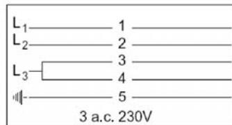
Si vous souhaitez faire une connexion fixe, veillez à ce qu'un interrupteur omnipolaire avec une distance de contact de 3 mm au minimum soit installé dans la conduite d'alimentation.
