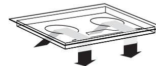
De elektronica in het toestel heeft koeling nodig. Aan de onderzijde van het toestel bevinden zich de ventilatieopeningen. Door deze openingen moet koele lucht aangezogen kunnen worden. Aan de voorzijde en onderzijde is het toestel voorzien van uitblaasopeningen.
