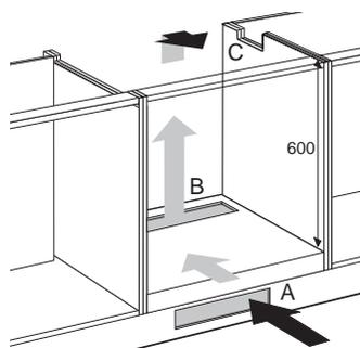
Nismaat minimaal 600 mm hoog. Beluchting vindt plaats via plint en achterzijde oven. Bij een oven moet er aan de voorzijde een opening gemaakt worden van minimaal 560 x 6 mm. Zaag de beluchtingsopeningen "A" + "B" uit (100 cm<sup>2</sup>). Maak een uitsparing "C" in de zijwand van de keukenkast voor het doorvoeren van de aansluitkabel. De kookplaat mag alleen met ATAG-ovens worden gecombineerd, niet met combitrans.
