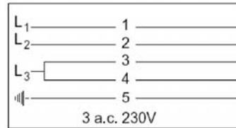
Wenn Sie einen festen Anschluss herstellen möchten, achten Sie darauf, dass ein allpoliger Schalter mit einer Kontaktöffnung von mindestens 3 mm in der Zufuhrleitung installiert wird.
