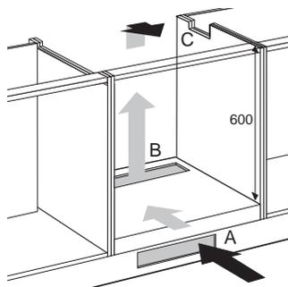
Evidemment 600 mm de hauteur minimum. L'aération se produit via la plinthe et l'arrière du four. Avec un four, il faudra effectuer à l'avant une fente d'au moins 560 x 6 mm. Découpez à la scie les ouvertures d'aération "A" + "B" (100 cm<sup>2</sup>). Faites un évidement "C" dans la paroi latérale du placard de cuisine avant de faire passer le câble de raccordement. La plaque de cuisson ne se combine qu'avec les fours ATAG, pas avec les combitrans.
