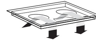
Die Elektronik im Gerät braucht Kühlung. An der Unterseite des Gerätes befinden sich die Lüftungsöffnungen. Die Möglichkeit muss gegeben sein, dass durch diese Öffnungen kühle Luft ausgeblasen werden kann. An der Vorderseite ist das Gerät mit Ausblasöffnungen ausgestattet. Zur optimalen Kühlung des Kochgerätes sind am Küchenmöbel ein paar Änderungen vorzunehmen.
