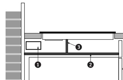
Plaats, voor afscherming van de luchtstroom, een schermpaneel van het zelfde materiaal als de schermplaat tussen de schermplaat en de kookplaat. Beluchting vindt plaats via de naastliggende kasten.
