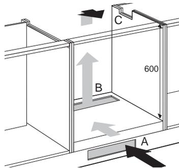
Nischenmaß mindestens 600 mm hoch. Die Belüftung erfolgt über die Sockelblende und an der Ofenrückseite. Bei einem Ofen ist vorne für einen Schlitz von mindestens 560 x 6 mm zu sorgen. Sägen Sie die Belüftungsöffnungen "A" + "B" aus (100 cm<sup>2</sup>). Sägen Sie einen Ausschnitt "C" in die Seitenwand des Küchenschrankes zur Durchführung des Anschlusskabels. Das Kochfeld darf nur mit Pelgrim Backöfen kombiniert werden, nicht mit Combitrons.
