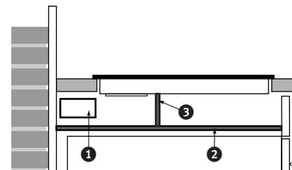
Placez pour masquer le courant d'air un panneau de protection entre la plaque de protection et la plaque de cuisson. Le matériel doit être le même que la plaque de protection. L'aération se fait par les placards qui se trouvent à côté.
