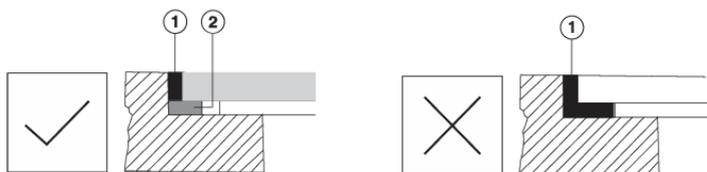
1. Mastic au silicone, 2. Joint d'étanchéité en ruban
