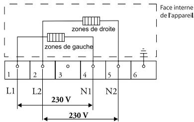
**Connexion 3 phases avec 1 neutre (3 1N ca 400 V / 50 Hz / Groupe de puissance) :** La tension entre les phases et le neutre est de 230 V ca. Entre les phases, il y a une tension de 400 V. Placez un pont de liaison entre les points de connexion 4-5. Phase 3 ne sera pas chargée. Vos groupes doivent avoir au minimum des fusibles de 16 A (3x). Le câble de connexion doit avoir une section du conducteur de 2,5 mm<sup>2</sup> au minimum.
