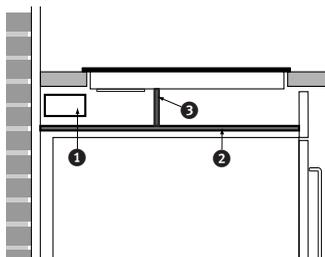
2 Plaats een schermplaat tussen de oven en de kookplaat. De plaat moet minimaal 10 mm dik zijn en hittebestendig (85 °C). De ruimte tussen de onderzijde van de kookplaat en schermplaat moet minimaal 50 mm bedragen.
