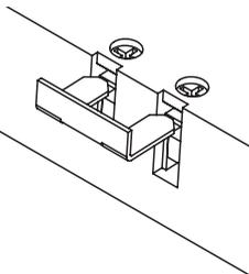
Met de op het aansluitblok aanwezige bruggen kunt u de vereiste doorverbindingen maken zoals in voorgaande illustraties staat aangegeven. In het deksel van het aansluitkastje en in onderstaande illustratie staat aangegeven hoe u de bruggen aan moet brengen. Deze moeten niet meteen bovenop de aansluitdraden worden geplaatst, maar tussen de schroefkop en de klem om de aansluitdraad. Zet de kabel vast met de trekcontlating en sluit het deksel.
