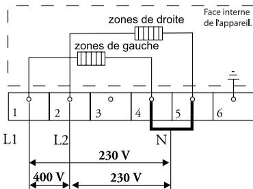
Placez un pont de liaison entre les points de connexion 4-5. Vos groupes doivent avoir au minimum des fusibles de 16 A (2x). Le câble de connexion doit avoir une section du conducteur de 2,5 mm<sup>2</sup> au minimum.
