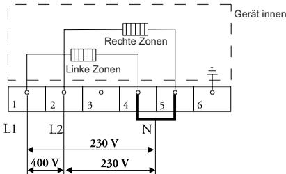
Sorgen Sie für eine Verbindungsbrücke zwischen den Anschlussstellen 4-5. Ihre Gruppen müssen mit minimal 16 A (2 Sicherungen) abgesichert sein. Das Anschlusskabel muss einen Aderdurchmesser von mindestens 2,5 mm<sup>2</sup> haben.
