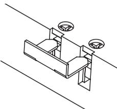
Mit den auf der Anschlussleiste vorhandenen Brücken können die erforderlichen Verbindungen hergestellt werden, wie in obigen Illustrationen angegeben. Im Deckel des Anschlusskastens und in untenstehender Illustration ist angegeben, wie die Brücken anzubringen sind. Sie sind nicht unmittelbar über den Anschlussdrähten anzubringen, sondern zwischen dem Schraubenkopf und der Klemme um den Anschlussdraht. Befestigen Sie das Kabel mit der Zugentlastung und schließen Sie den Deckel.
