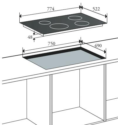
Er is een bepaalde nismaat nodig wanneer de kookplaat boven een oven wordt geplaatst. Deze benodigde nismaat is afhankelijk van het volgende:
