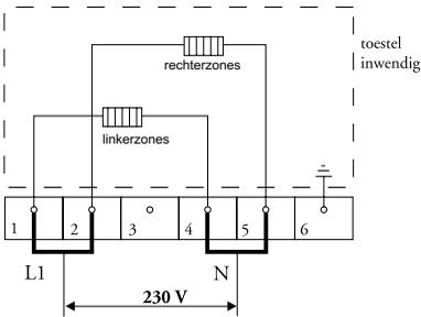
Breng verbindingsbruggen aan tussen de aansluitpunten 1-2 en 4-5. Uw groep moet afgezekerd zijn met minimaal 32 A. De aansluitkabel moet een aderdoorsnede hebben van minimaal 6 mm<sup>2</sup>.
