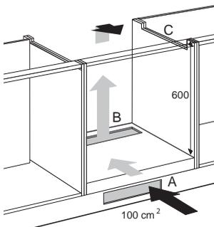
Die Belüftung erfolgt über die Sockelblende und an der Ofenrückseite.
