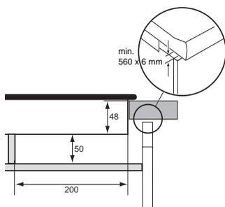
3 Plaats, voor afscherming van de luchtstroom, een schermpaneel, van het zelfde materiaal als de schermplaat, tussen de schermplaat en de kookplaat. Ontluchting vindt plaats via de naastliggende kasten.
