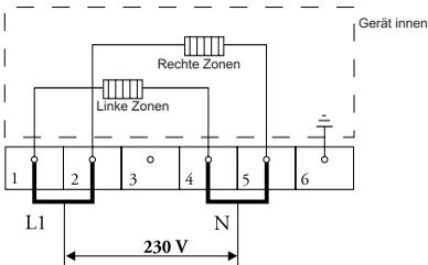
Bringen Sie zwischen den Anschlussstellen 1-2 und 4-5 die Verbindungsbrücken an. Ihre Gruppe muss mit Sicherungen von minimal 32 A abgesichert sein. Das Anschlusskabel muss einen Aderdurchmesser von mindestens 6 mm<sup>2</sup> haben.
