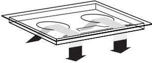
Die Elektronik im Gerät braucht Kühlung. An der Unterseite des Gerätes befinden sich die Lüftungsöffnungen. Die Möglichkeit muss gegeben sein, dass durch diese Öffnungen kühle Luft angesaugt werden kann. An der Vorderseite ist das Gerät mit Ausblasöffnungen ausgestattet. Zur optimalen Kühlung des Kochgerätes sind am Küchenmöbel ein paar Änderungen vorzunehmen.
