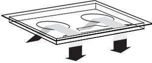
De elektronica in het toestel heeft koeling nodig. Aan de onderzijde van het toestel bevinden zich de ventilatieopeningen. Door deze openingen moet koude lucht aangezogen kunnen worden. Aan de voorzijde is het toestel voorzien van uitblaasopeningen.
