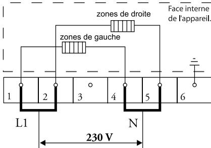
Placez les ponts de liaison entre les points de connexion 1-2 et 4-5. Votre groupe doit être équipé de fusibles de 32 A au minimum. Le câble de connexion doit avoir une section du conducteur de 6 mm<sup>2</sup> au minimum.
