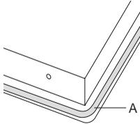
2. Éliminez la feuille de protection de la bande d'étanchéité (A) et collez la bande dans la rainure des profils en aluminium.
