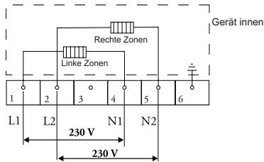
**3-Phasen-Netzanschluss mit 1 Nulleiter (3 1N Wechselstrom 400 V / 50 Hz / Energiegruppe):**
