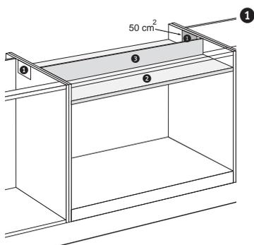
1 Zaag de beluchtingsopening(en) uit zodat de totale oppervlakte van de gaten minimaal 100 cm<sup>2</sup> is. Zie bijvoorbeeld figuur met twee gaten van 50 cm<sup>2</sup>.
