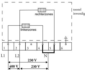
Breng een verbindingsbrug aan tussen de aansluitpunten 4-5. Uw groepen moeten afgezekerd zijn met minimaal 16 A (2x). De aansluitkabel moet een aderdoorsnede hebben van minimaal 2,5 mm<sup>2</sup>.
