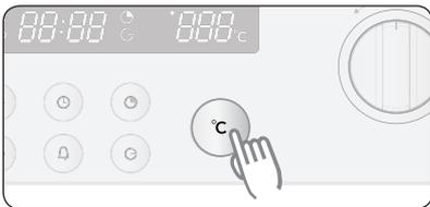
**1** Drücken Sie die **Temperaturtaste** (für die Einstellung des oberen Garraums). Drücken Sie die **Temperaturtaste** zweimal (für die Einstellung des unteren Garraums).
