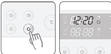
**3** Drücken Sie die **Taste für Garzeitende**. Der Backofen läuft dann automatisch bis zur eingestellten Endzeit, sofern nicht die **Taste für Garzeitende** innerhalb von 5 Sekunden nochmals gedrückt wird.
