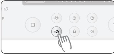
**1** Drehen Sie die Funktionstaste auf die 'aus'-Stellung. Drücken Sie die Kindersicherungstaste und halten Sie sie 3 Sekunden gedrückt. Im Display wird das Symbol
