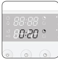
**3** Drücken Sie die **Garzeit-Taste**. Der Backofen läuft dann automatisch für die Dauer der eingestellten Garzeit, sofern nicht die **Garzeit-Taste** innerhalb von 5 Sekunden nochmals gedrückt wird.
