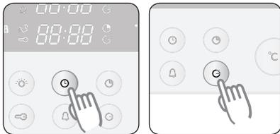
**1** Wenn Sie den Signalton ausschalten möchten, drücken Sie gleichzeitig die **Uhrzeitstaste** und die **Taste für Garzeitende**, und halten Sie die beiden Tasten 3 Sekunden lang gedrückt.
