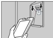
1. Halten Sie die Unterseite der Seitenlampe mit einer Hand fest. Schieben Sie mit der anderen Hand einen scharfen Gegenstand, wie etwa ein Brotmesser, zwischen die Schutzkappe und das Gehäuse und lösen Sie so die Schutzkappe.
