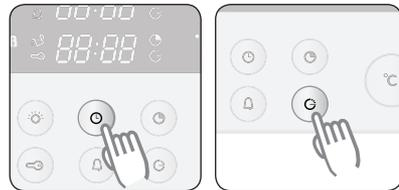
**2** Wenn Sie den Signalton wieder einschalten möchten, drücken Sie wieder gleichzeitig die **Uhrzeitstaste** und die **Taste für Garzeitende**, und halten die beiden Tasten 3 Sekunden lang gedrückt.
