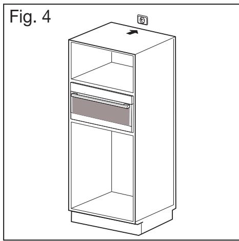
Fig. 1 Schuif de oven gedeeltelijk in de daarvoor bestemde ruimte. Geleid de voedingskabel naar de contactdoos.
