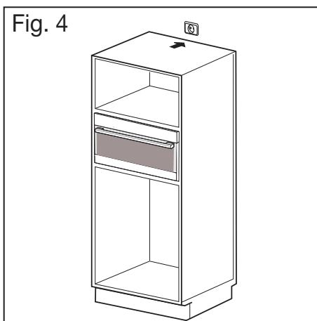
Fig. 1. Faites glisser le four partiellement dans le renforcement. Amenez le câble de raccordement à la source d'alimentation.
