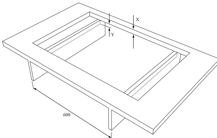
dimensions d'encastrement HG76/77/96/97..MB et HG96..SB dans corpus de 60 cm
