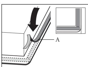
Eliminez la feuille de protection de la bande d'étanchéité (A) et collez la bande dans la rainure des profils en aluminium ou de la plaque de verre. Ne passez pas le ruban d'obturation dans les angles, mais coupez 4 morceaux qui se rejoignent bien entre eux dans les angles.
