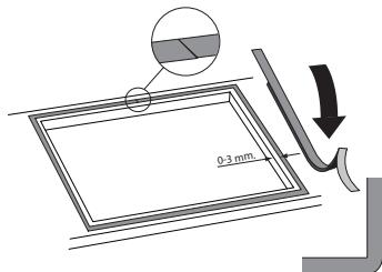
Enlevez le film de protection de la bande d'étanchéité et collez la bande autour de la découpe du plan de travail. Commencez par l'arrière de l'appareil et collez la bande d'étanchéité dans les coins. Veillez à ce que les extrémités de la bande d'étanchéité reposent bien les unes contre les autres.
