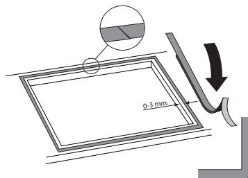
Verwijder de beschermfolie van het afdichtband en plak het band rondom de uitsparing in het werkblad. Begin aan de achterzijde van het toestel en plak het afdichtband door de hoeken. Zorg ervoor dat de uiteinden van het afdichtband goed op elkaar aansluiten.
