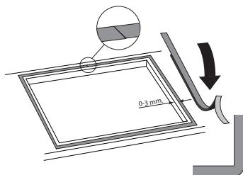
Entfernen Sie die Schutzfolie des Dichtungsstreifens und kleben Sie den Streifen rund um die Aussparung in der Arbeitsplatte. Beginnen Sie an der Rückseite des Geräts und kleben Sie den Dichtungsstreifen über die Ecken. Achten Sie darauf, dass die Enden des Dichtungsstreifens gut aneinander anschließen.
