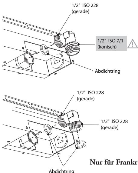
Montieren Sie den mitgelieferten Krümmer auf den Gasanschluß des Gerätes.
