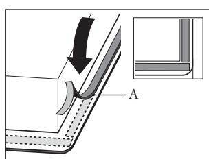
Verwijder de beschermfolie van het afdichtband (A) en plak het band in de groef van de aluminium profielen of op de rand van de glasplaat. Plak het afdichtband niet door de hoek, maar knip 4 stukken die goed aansluiten in de hoek.
