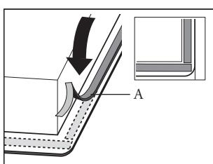
Entfernen Sie die Schutzfolie des Dichtungsstreifens (A) und kleben Sie den Dichtungsstreifen in die Rille der Aluminiumprofile oder an die untere Seite der Glasplatte. Das Dichtungsband nicht durch die Ecken kleben, sondern 4 Stücke schneiden, die in den Ecken für eine gute Verbindung sorgen.
