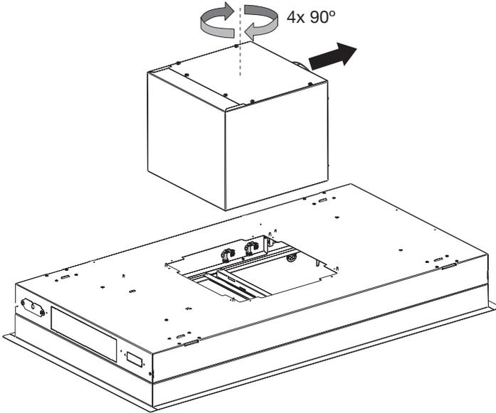
Plaats de motor extern / Placer le moteur à l'extérieur /
