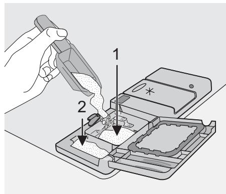
3. Tous les programmes avec prélavage nécessitent une dose supplémentaire de produit de lavage (5 à 10 g) à placer dans le compartiment de prélavage (2). Ce produit de lavage agira au cours de la phase de prélavage.
