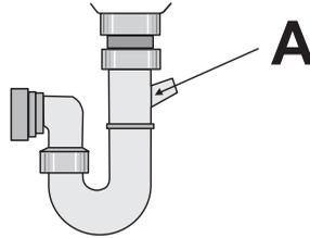
**i** Onze apparaten worden geleverd met een veiligheidsvoorziening die ervoor zorgt dat vuil water niet terug kan lopen in de machine. Als uw gootsteenafvoer is voorzien van een geïntegreerde terugslagklep kan dit een goede waterafvoer van uw afwasmachine in de weg staan. Wij adviseren u dan ook de terugslagklep te verwijderen.
