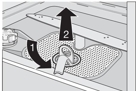
4. Fassen Sie den Grobfilter (A) am Handgriff und ziehen Sie ihn aus dem Mikrofilter (B).
