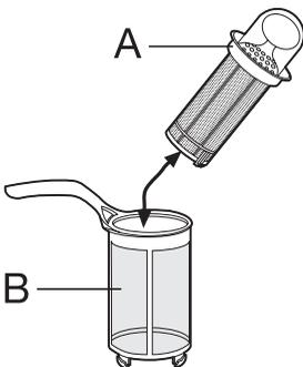
3. Drehen Sie den Griff um 1/4 Umdrehung nach links und ziehen Sie das Filtersystem heraus
