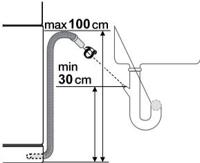
De afvoerslang kan vanaf de afwasmachine naar links of naar rechts lopen. Verzeker u ervan dat de slang niet gebogen is of platgedrukt wordt, aangezien dit de afvoer van water kan vertragen of in de weg staan.
