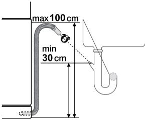
Der Abflussschlauch kann nach rechts oder links verlegt werden.
