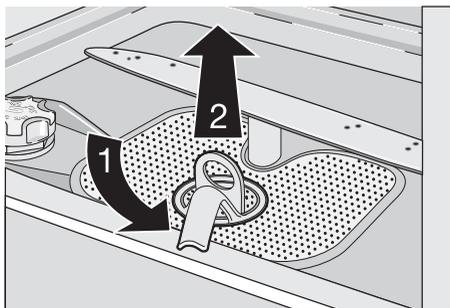
4. Pak het grof filter **(A)** beet bij de greep en verwijder het microfilter **(B)**.
