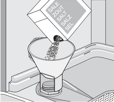
4. Die Verschlusskappe wieder anbringen und sicherstellen, dass kein Salz auf dem Gewinde oder der Dichtung vorhanden ist.
