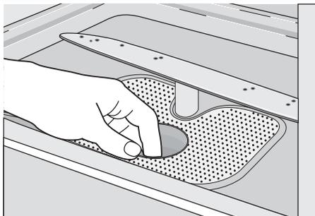
7. Plaats het platte filter terug in de bodem van het afwascompartiment en controleer of het filter goed op zijn plaats zit.
