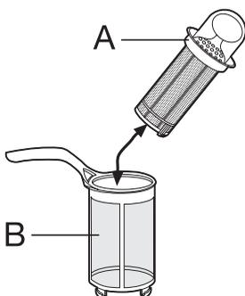
3. Draai de greep ongeveer een kwartslag naar links en verwijder het filtersysteem
