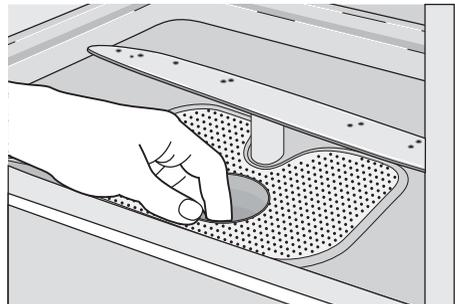
7. Setzen Sie das Filtersieb wieder in den Spülraumboden ein und vergewissern Sie sich, dass es fest sitzt.
