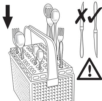
Als de handgrepen onder de bestekmand uitsteken en de onderste sproeiarm in zijn beweging belemmeren, dient het bestek met de handgrepen omhoog te worden geplaatst.
