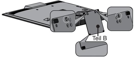
6. Montieren Sie dann Teil B mit 6 Schrauben (M5 × 16).
