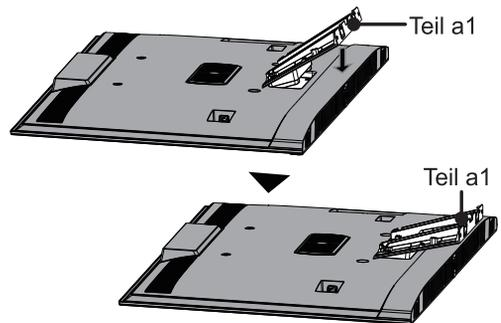
4. Befestigen Sie Teil a1 mit 4 Schrauben (M5 × 12) an der Rückwand des Fernsehers.
